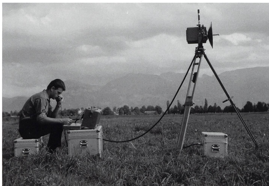
Abb. 8: Zur Messung einer Strecke von 100 m bis 50 km wird an jedem Endpunkt ein DI50 aufgestellt und die Distanz mittels der Laufzeit der Mikrowellenstrahlung gemessen.
