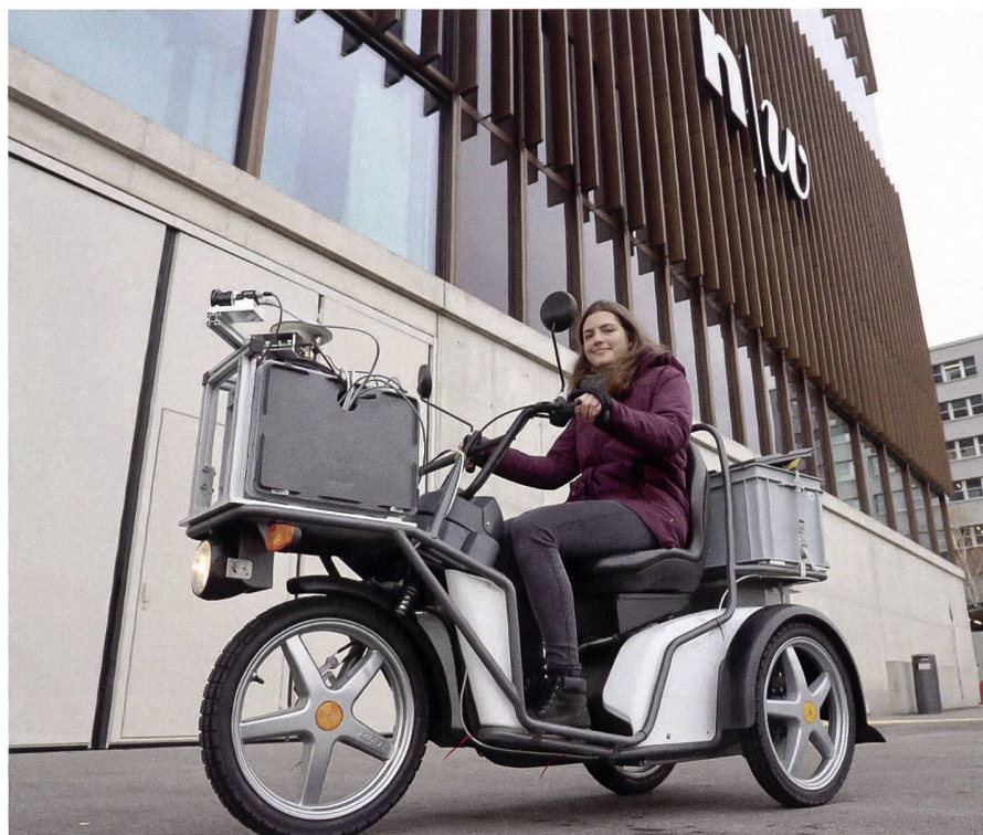
Abb. 6: Neues elektrisch betriebenes Mobile Mapping Forschungsfahrzeug des IGEO mit einem experimentellen Messaufbau für das mobile Parkplatzmonitoring (Projekt BiPaMo und Masterthesis Jasmin Frey).
