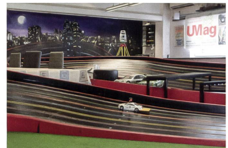
Abb. 1: Tracking eines Slotracing-Rennwagens mit einer Leica Multistation MS60 (Wolf, 2020).
