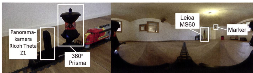
Abb. 2: 360°-Aufnahme der Panoramakamera in der Homeoffice-Testumgebung.
