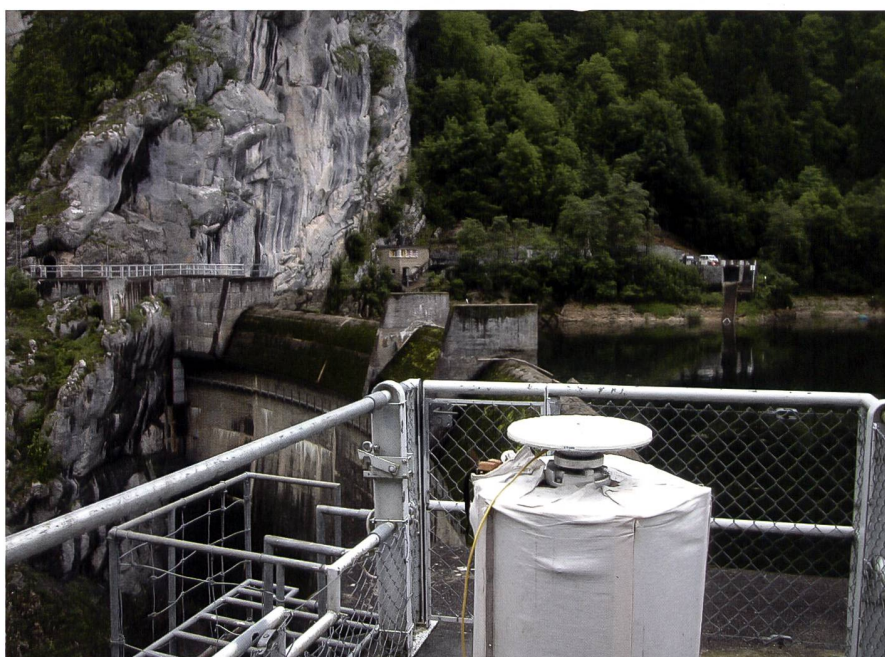
Fig. 6: antenne GPS Trimble 5700/Zephyr (2008) sur le barrage du «Châtelot» (© swisstopo).
