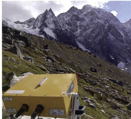
Fig. 8: interféromètre radar terrestre et l'exploitation des mouvements au Piz Cengalo, Bondo (© Geopraevent AG).
