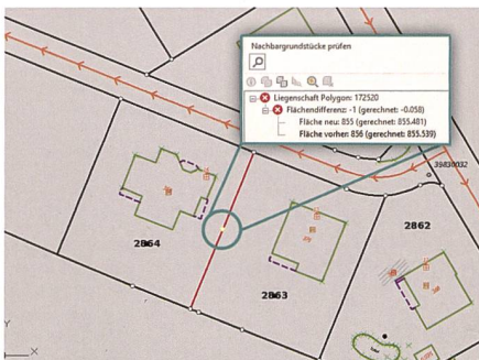
Abb. 1: Flächenprüfung Nachbargrundstück (im Konstruktionsplan).
