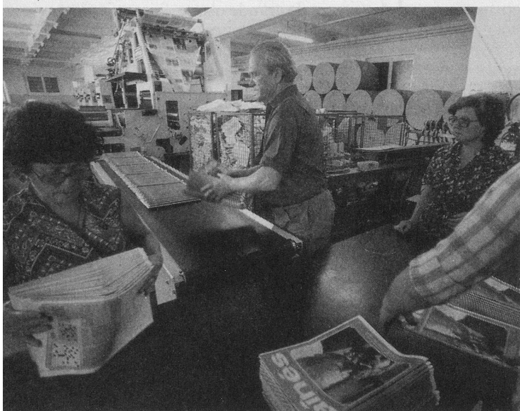
Depuis 9 ans l'impression d'«Aînés» est confiée aux Presses Centrales Lausanne S.A. Ici la rotative offset en service depuis 1977.
