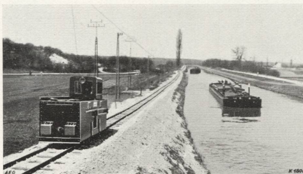
Abb. 75 (oben). Hüniger Kanal. Treideln mit Pferden. Abb. 76 (unten). Hüniger Kanal. Elektrisches Treideln.
