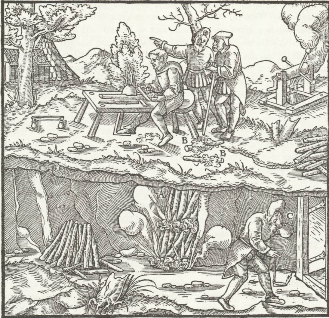
Abbau des Erzes durch Feuersetzen
