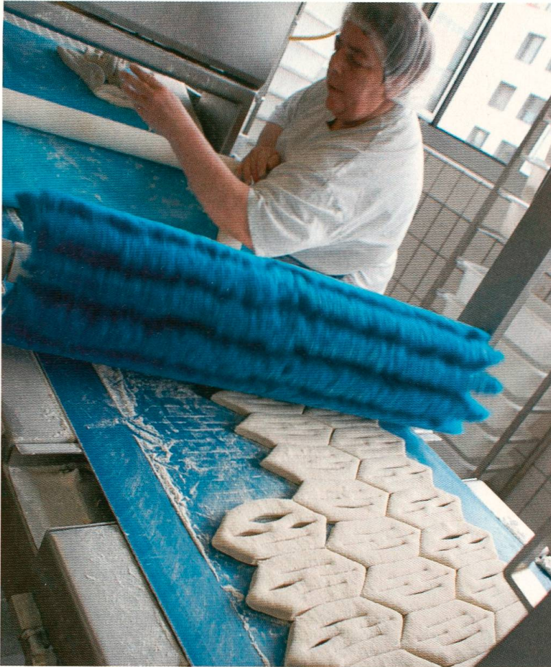
Abb. 69 In der Regionalbäckerei Jowa AG Birsfelden wird nach dem Stanzvorgang überschüssiges Mehl von den Teiglingen gebürstet und rezykliert.
