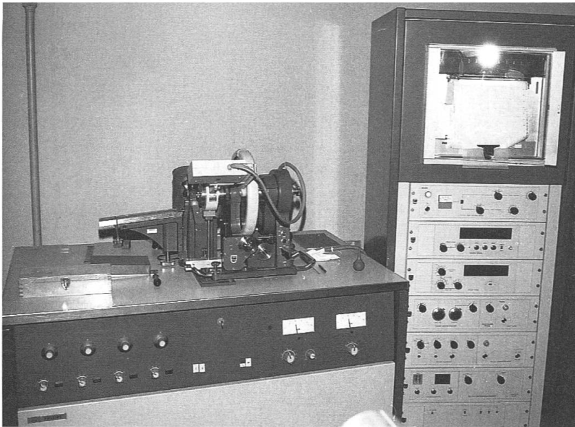
Abb. 17: Manuelles Röntgendiffraktometer, von 1968 bis 1985 in Betrieb.
