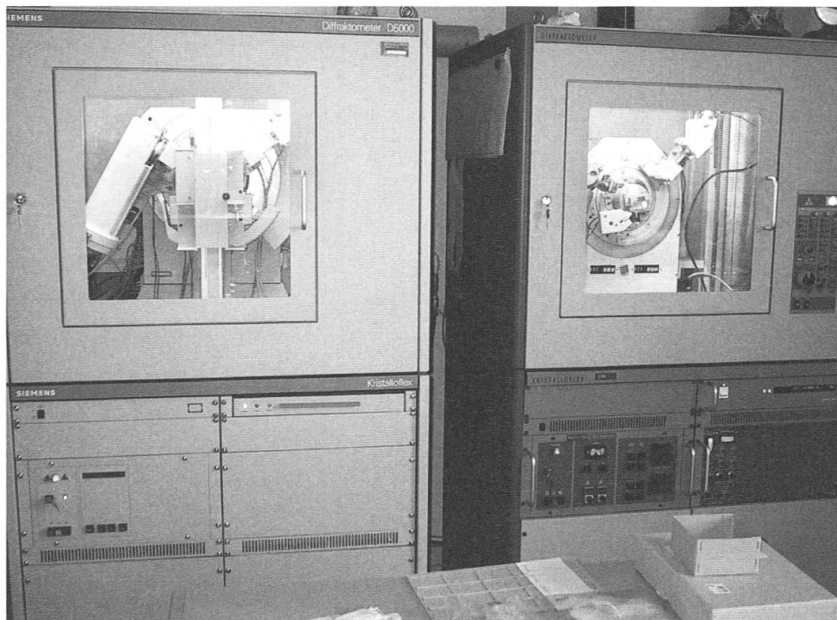
Abb. 18: Zwei über PCs programmgesteuerte Röntgendiffraktometer (1984, 1993), von denen eines (links) mit einem Probenwechsler ausgerüstet ist. Im Unterbau befindet sich jeweils der Hochspannungsgenerator, im oberen Teil das eigentliche Diffraktometer mit wassergekühlter Röntgenröhre, Probenhalter und Zählrohrgoniometer im Strahlenschutzgehäuse.
