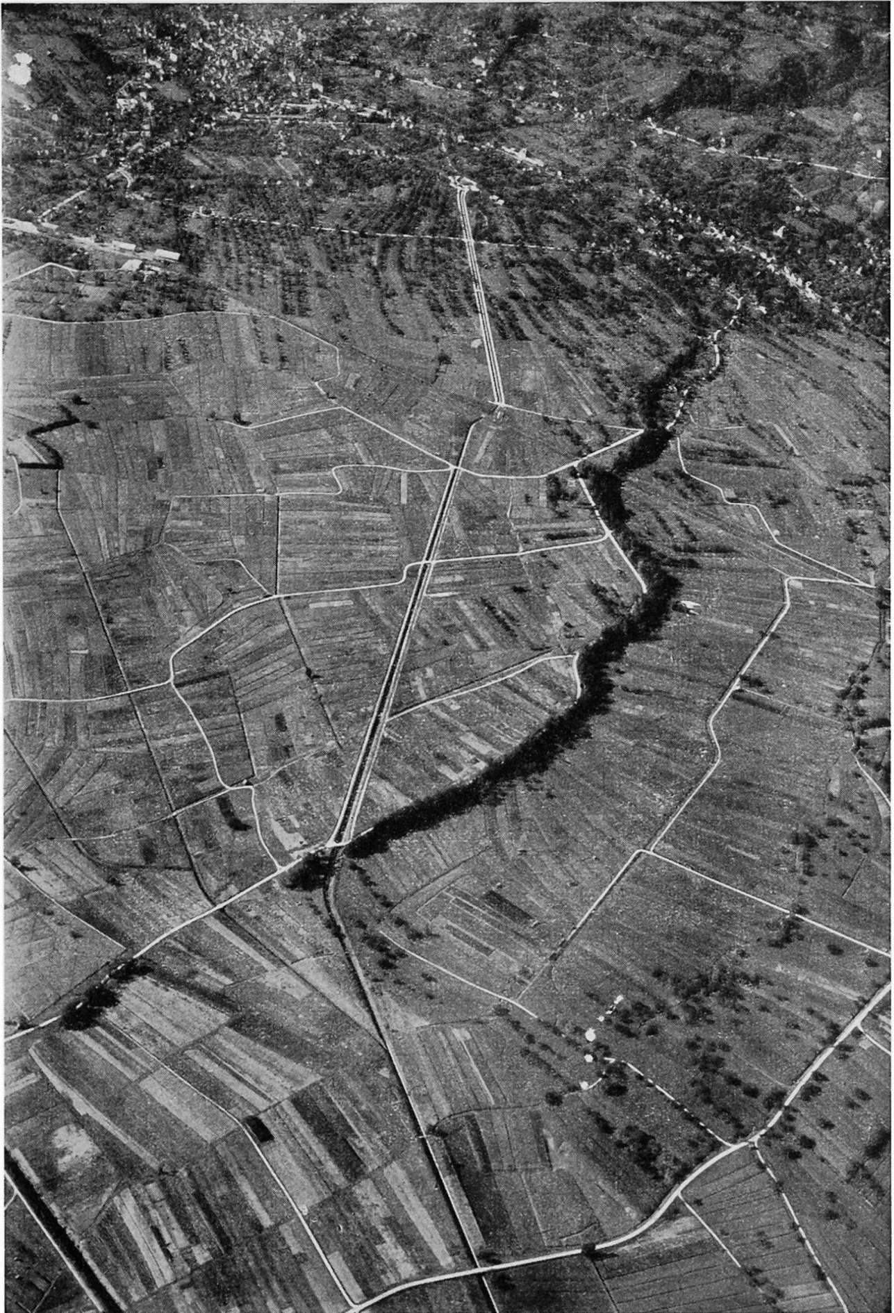
Abb. 12. Melioration der Rheinebene Altstätten. Alter Kesselbach als Windschutz und neuer Kesselbach mit Kiesfang und Parallelwegen. (Photo: Militärflugdienst Nr. 271/58)
