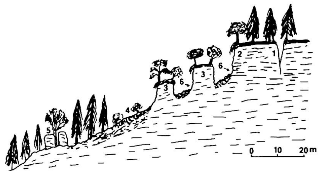
Figure 1 Le Château Cugny: coupe schématique des lieux. 1. échancrure profonde, 2. paroi principale avec racines d'arbres pendant dans le vide, 3. «châteaux», 4. éboulis, 5. gros blocs éboulés, 6. localisation des mesures.
