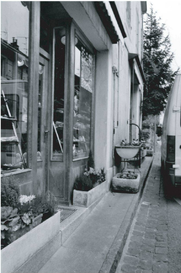
Photo 3: Trottoir trop étroit pour les chaises roulantes Sidewalk too narrow for wheelchairs Zu schmales Trottoir für Rollstuhlfahrer Photo: M. FREEDMAN
