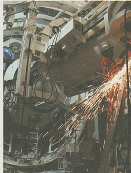
Nelle foto: momenti in sequenza delle fasi di trasporto e montaggio della fresatrice S-210, avviata il 7 novembre 2002 nell'ambito di un evento ufficiale.
