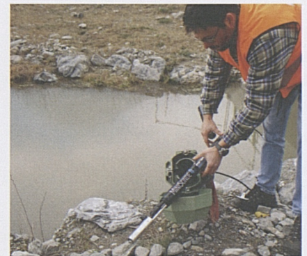
Sonde zur Messung der Wasserqualität im Walenbrunnens.
