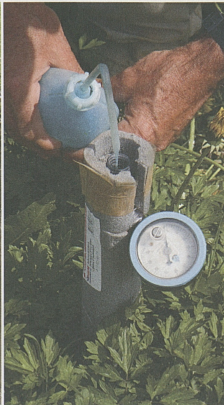
Feuchtigkeitsmessung im Boden.
