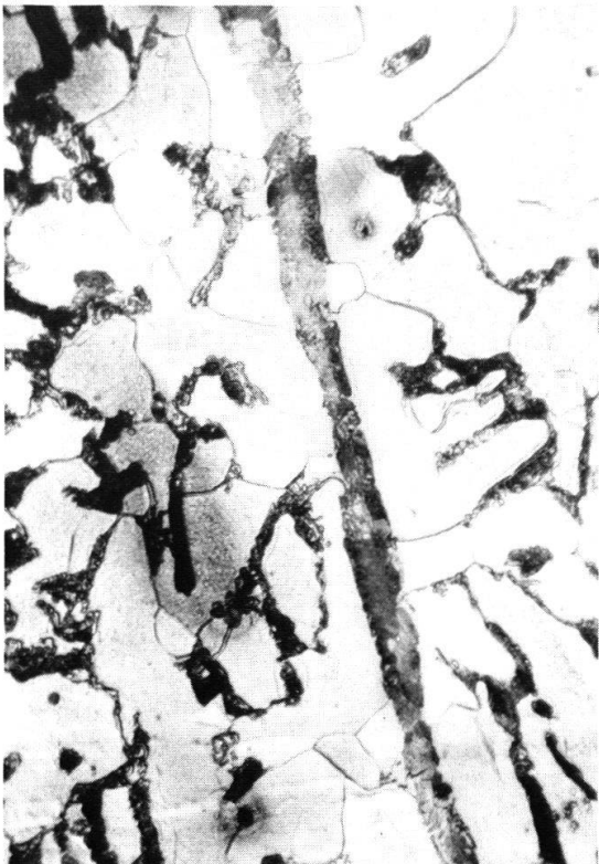
Abb. 4 Mikrostrukturen des Schwertes aus Augst (Inventarnr. 1961.4401) in der mittleren Klingenzone: a) Gesamtbild, V = 45 \times (Abb. 20 \times ); b) rechte Deckschicht, Ferrit + Perlit, V = 300 \times ; c) Schweissnahtstelle zwischen Kern und der rechten Deckschicht, Ferrit + Perlit, V = 600 \times ;
