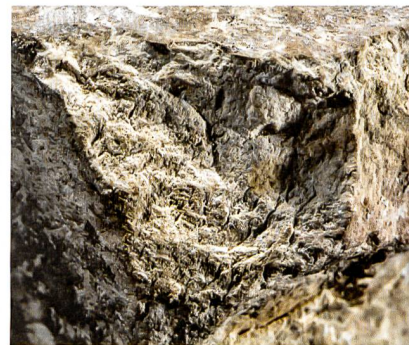
Abb. 22: Feinkörnige, homogene Ausprägung des kreidigen Kalkes. M. 1:1.
