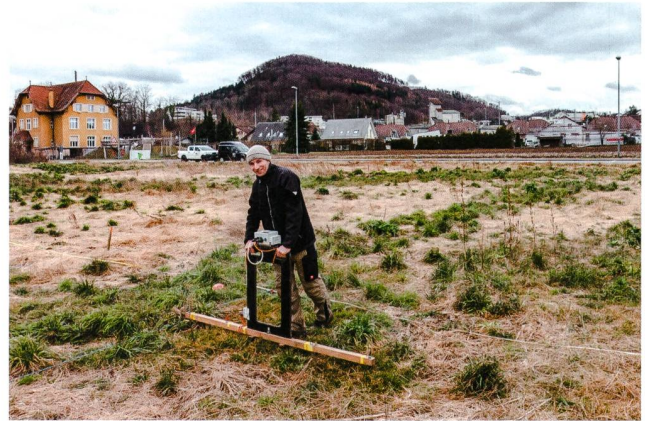
Abb. 28: Gebenstorf-Schulstrasse 2018 (Geb.018.2). Blick von Nordwesten auf die geophysikalisch vermessene Fläche vor der Arealüberbauung. Manuel Buess bei der geoelektrischen Prospektion. Im Hintergrund das Gebenstorfer Horn.
