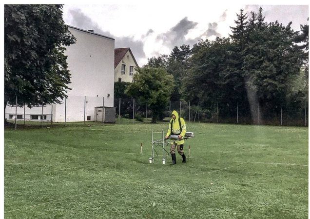
Abb. 21: Windisch-Breite (Geophysik) 2019 (V.019.6). Blick von Nordosten über die Rasenfläche südlich der Windischer Turnhalle. Manuel Buess bei der Prospektion mit dem zweiseitigen Magnetometer im Bereich des «Keltengrabens».
