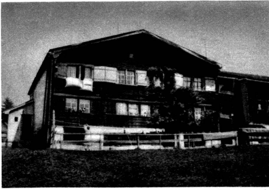
Appenzell : Voici l'ancien chalet du pays sans avant-toit latéral, mais la façade principale au midi est protégée, côté pluie, par un paravent en prolongement de la face ouest
