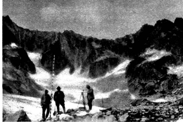
Fig. 8. — Levé topographique à la planchette en haute montagne. Les points caractéristiques et accessibles du terrain sont levés par mesurages optiques. D'autres points sont déterminés par intersections, en les visant de deux stations. Les courbes de niveau sont rarement suivies, mais simplement interpolées. Le dessin des formes des courbes et des détails de rochers par exemple est complété à vue d'œil. C'est un travail long et souvent pénible. La précision est forcément limitée et dépend des conditions locales.
