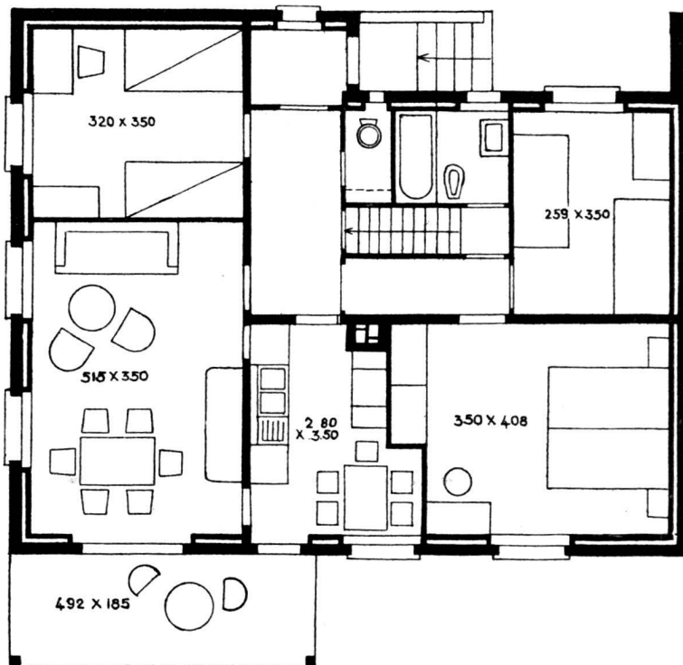
Groupe du « Mervelet ». Arnold Hœchel, architecte. Maison familiale de 5 pièces. Plan du rez-de-chaussée.
