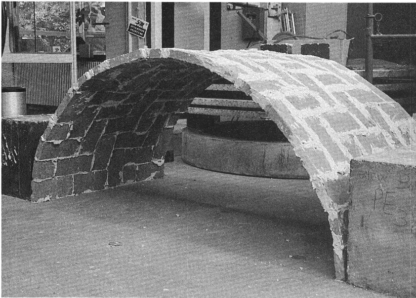
Voûte réalisée selon un appareillage traditionnel tunisien permettant la suppression du coffrage.
