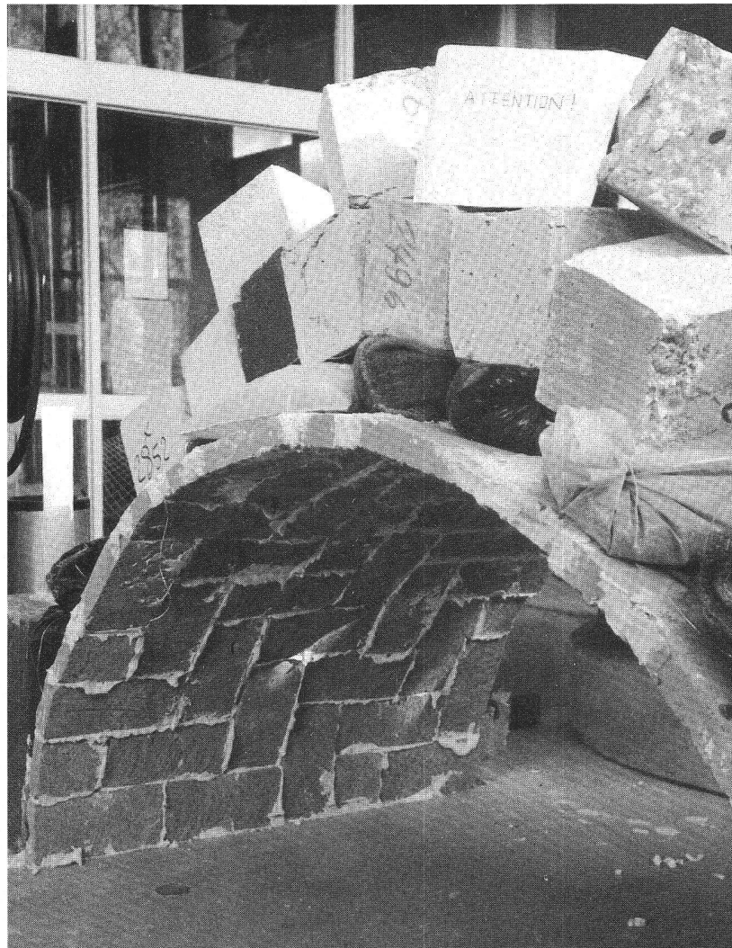
Voûte: essai de charge.
