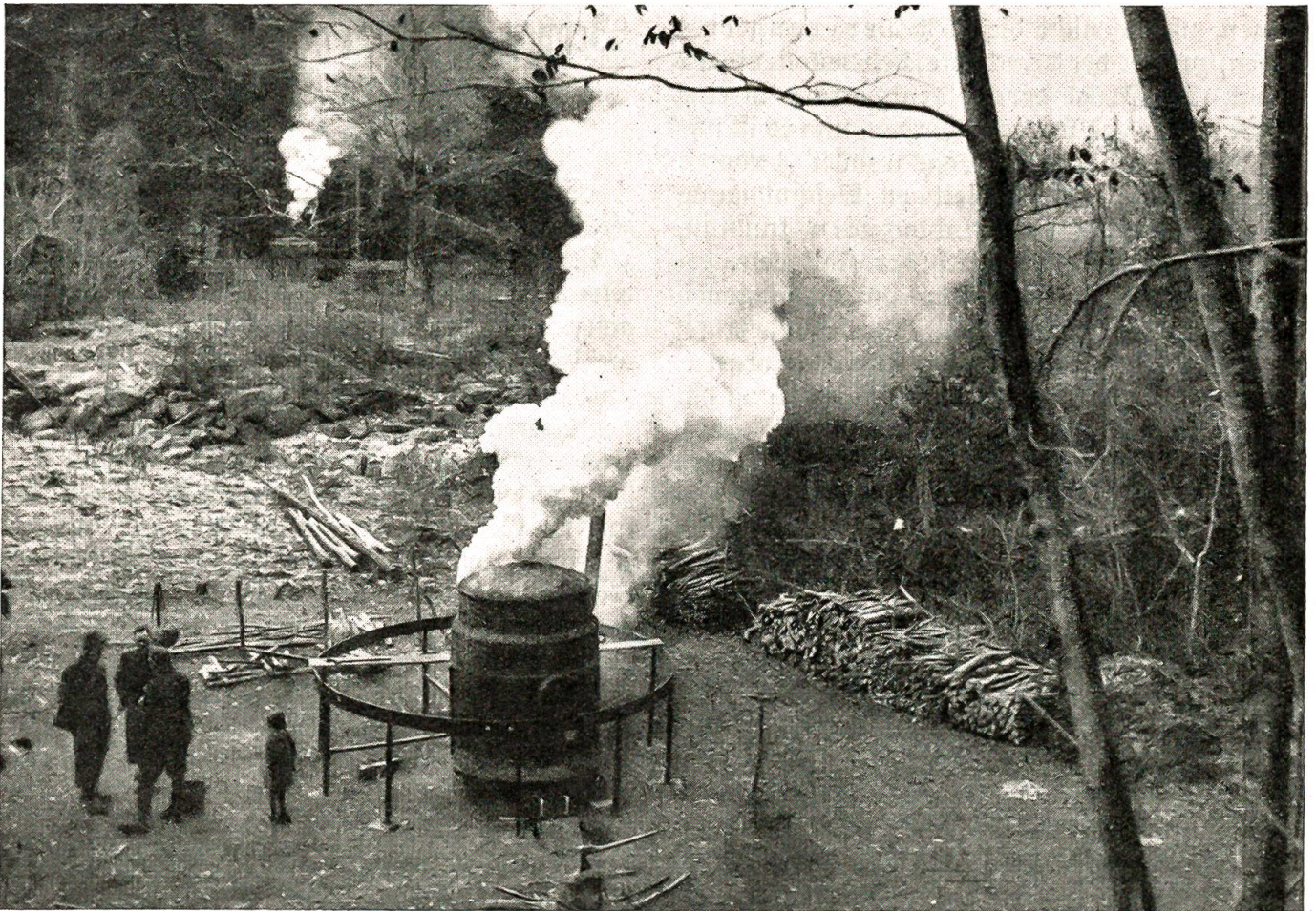
Dichte Rauchwolken entströmen den im Walde aufgestellten Öfen. An der Farbe des Rauches erkennt der Köhler, in welchem Stadium der Verkohlung sich das glühende Holz im Innern des Ofens befindet.
