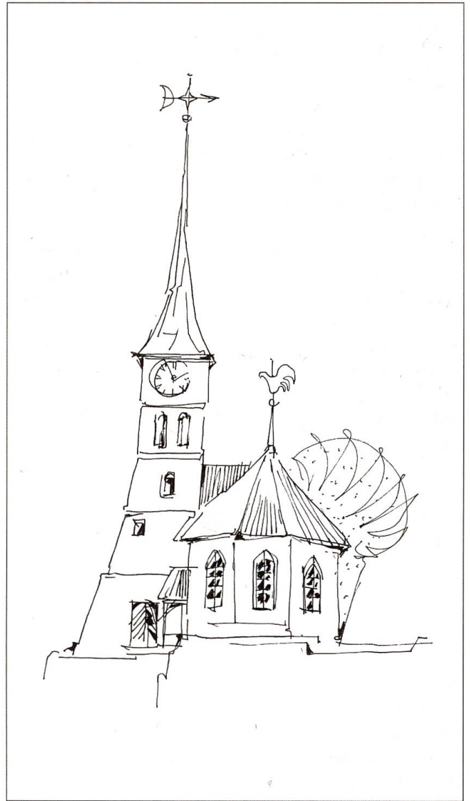
Nachdem sich der Kirchturm abgesenkt hatte, musste er gegen das Kirchenschiff mit Pfeilern abgestützt werden. Die obere Partie wurde 1913 senkrecht neu aufgebaut. (Skizze K. M.)
