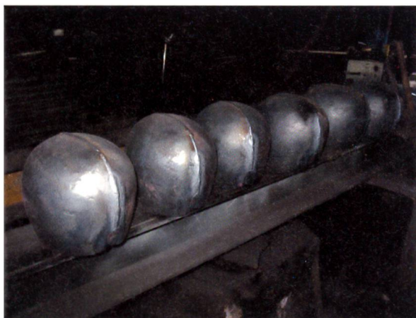
Treicheln werden aus Stahlblech geschmiedet.
