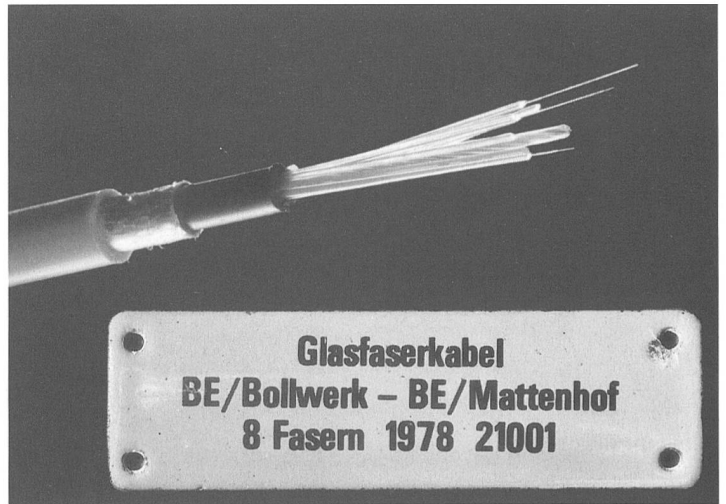
Glasfaser-Kabelmuster der ersten schweizerischen Glasfaser-Kabelanlage, Bollwerk-Mattenhof, Bern, 1978. Inv. 58144 (Geschenk Ernst Hadorn, Wabern)
