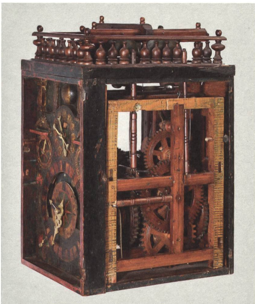
Blick von der Seite ins Räderwerk. Typisch für eine Berner Holzräderuhr sind die sechsspeichigen Zahnräder.
