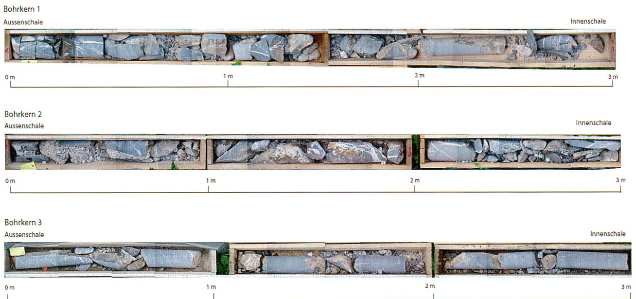
Abb. 7: Bohrkerne (Fotos AAM).
