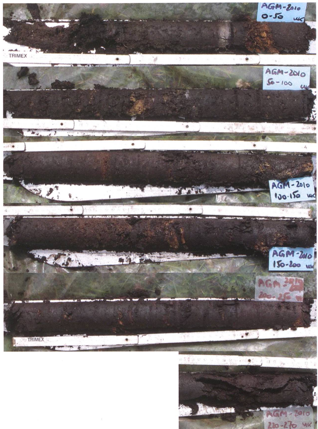
Abb. 3: Überblick über die entnommenen Bohrkern der Torfstratigraphie Hospental-Moos (0–270 cm Tiefe).
