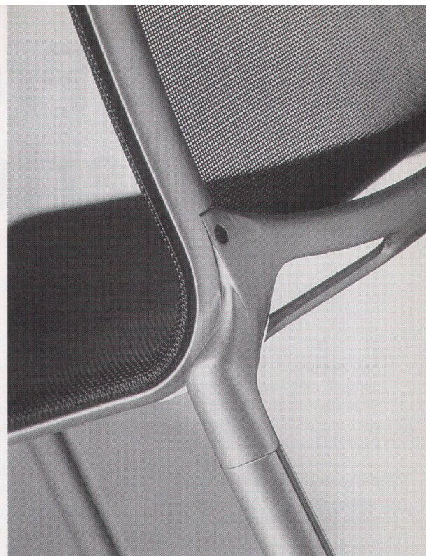
Das Press-Profil aus Alu wird ausgefräst, wo das Aluminium-Druckguss-Teil als Distanzhalter und Stabilisator angeschraubt wird
