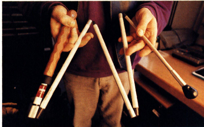
Der Stock hat gesamthaft sechs Rohrteile aus eloxiertem Aluminium, die Verbindung zwischen den unteren fünf Teilen bilden konische Abschlüsse. Das Ende des Stockes bildet der birnenförmige Tastkörper aus Spezial-Polyäthylen
