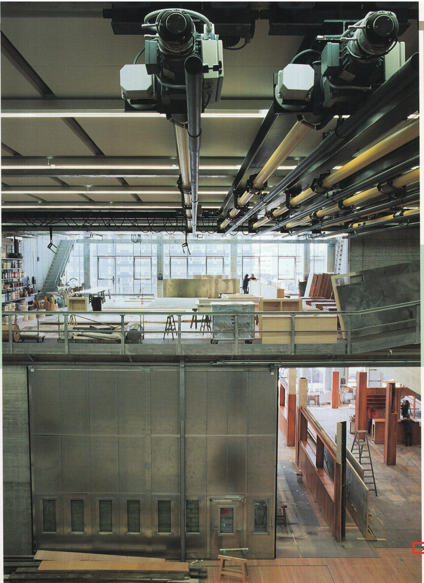
das werkzentrum als manufaktur. blick in das zentrum der produktion: die montagehalle und der obere und untere malersaal. die tore sind fünf meter hoch
