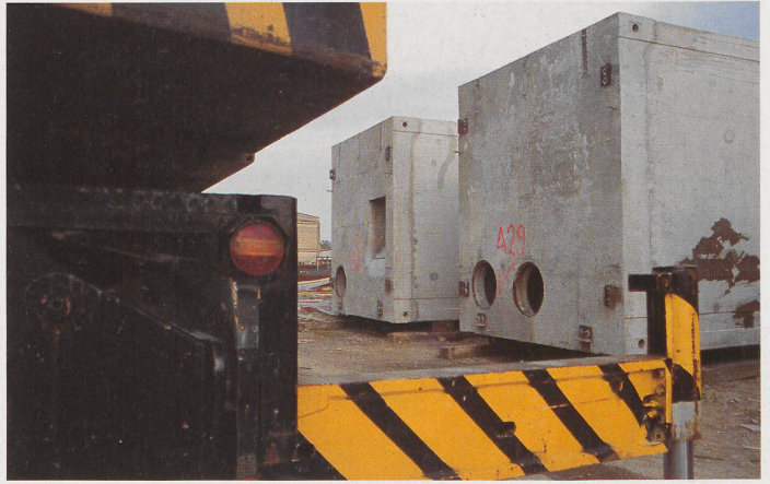
Die Produktion der hundert Schwimmkörper geschieht unter enormem Zeitdruck: Die Arbeiter der Firma Element in Tafers betonieren 15 Stunden am Tag. Dabei verlangt die Fertigung der 55-Kubikmeter-Kisten aus Leichtbeton Fingerspitzengefühl: Jedes Loch muss millimetergenau stimmen
