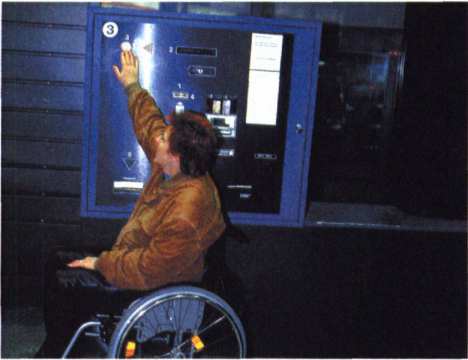
14 Der Kassa-Automat des Parkhauses liegt tief genug, der Weg vom Parkdeck zum Bahnareal ist schwellenlos.
