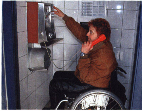
12 Positiv: Diese Swisscom-Telefonkabine ist gross genug, dass das Telefon sitzend bedient werden kann.
