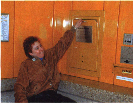
11 Diese Paketreihe ist gerade noch bedienbar, der Briefmarkenautomat liegt zu hoch.
