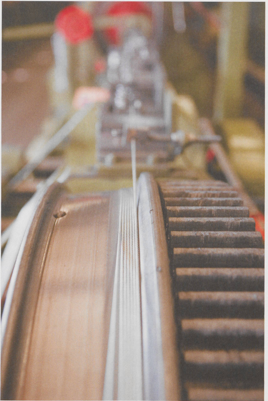
3 1 Im Nachformen steckt das Produktionskönnen: Es macht Drahtseile schnittfest.
