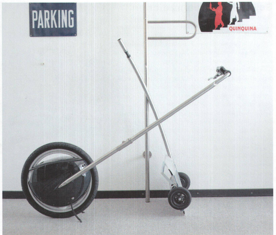
Fortbewegung, die Spass macht: das 32-Kilo-Gefährt mit Elektromotor. Ein Zusatz mit 2 Rädern macht den Glider zum Trottinett.
