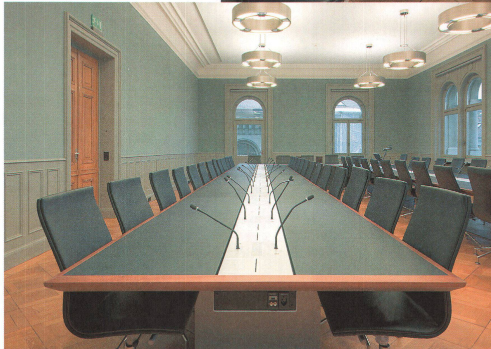
∨ Der Medienkanal in der Tischmitte ist zwar elegant, verursachte aber statische Probleme.
