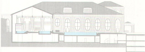
^ Schnitt B-B durch den Seitenflügel und das Aussenbecken.
