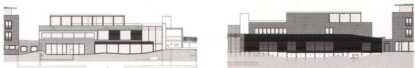
∧ Der dreigeschossige Flachdachbau verzichtet auf das ortstypische Sylter Reetdach.
