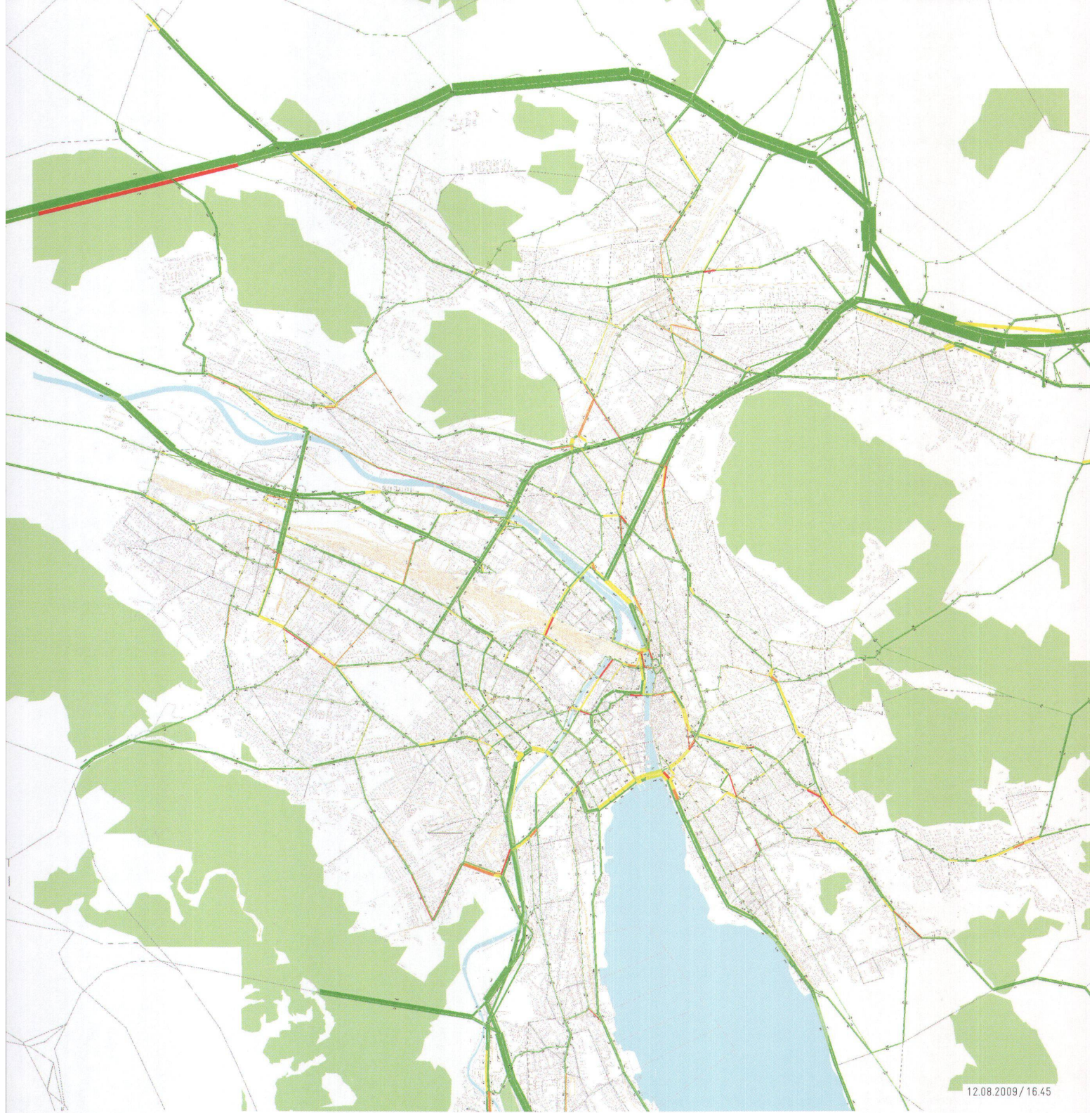
^Die Computer erfassen permanent die Frequenzen und zeigen sie auf dem Bildschirm: Je dicker die Linien, desto mehr Verkehr. Sind die Linien grün, dann rollts. Sind sie gelb oder orange, stockt der Verkehr. Rot bedeutet Stau. Das Bild zeigt einen Werktagabend im August 2009. Aktuelle Bilder gibts im Internet: www.zuerittraffic.ch
