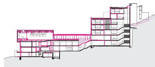
^ Schnitt durch Aula und Klassentrakt. Die rot eingetragenen Teile zeigen, wie tief greifend der Umbau war.
