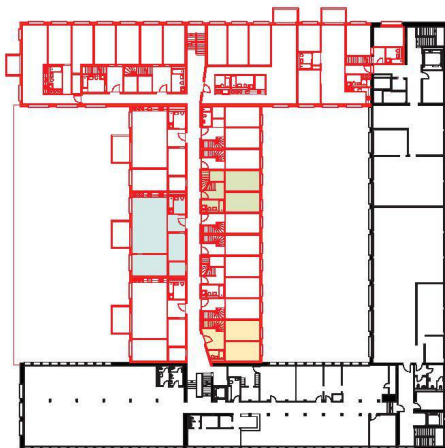
2. Obergeschoss: Ein langer Flur verbindet die beiden bestehenden Treppenhäuser.
