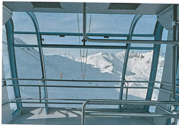
Haltestangen unterteilen den Innenraum der Urdenbahn-Kabine in drei Sektoren.
