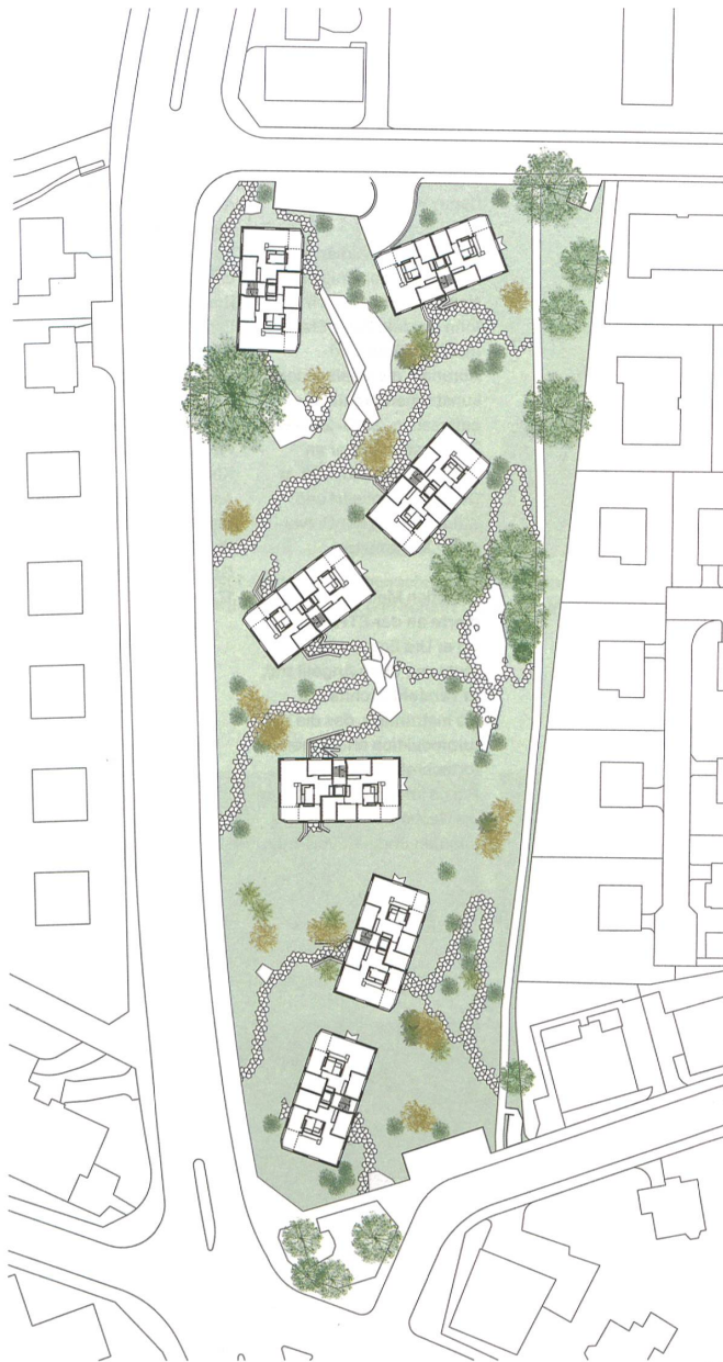
Weil die Wohnungen dreiseitig belichtet sind, bleiben die Grundrisse trotz unterschiedlicher Ausrichtung unverändert.
