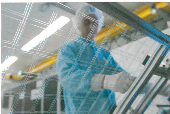
Vor der Produktion werden die Glasplatten auf Fehler untersucht.
