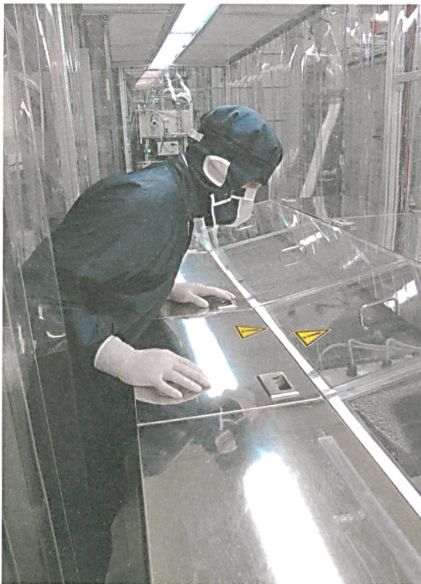
Ein Mitarbeiter im Reinraumanzug überwacht das Waschen der Substrate, auf denen die OLED entstehen.
