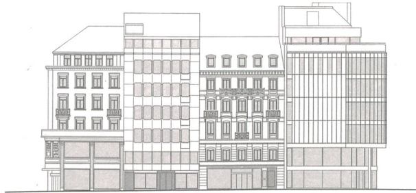
Nach dem Umbau ist die Ladenfront der «Modissa» grosszügiger geworden. Das Nachbarhaus hat man vor einigen Jahren wieder auf den Boden gestellt.
