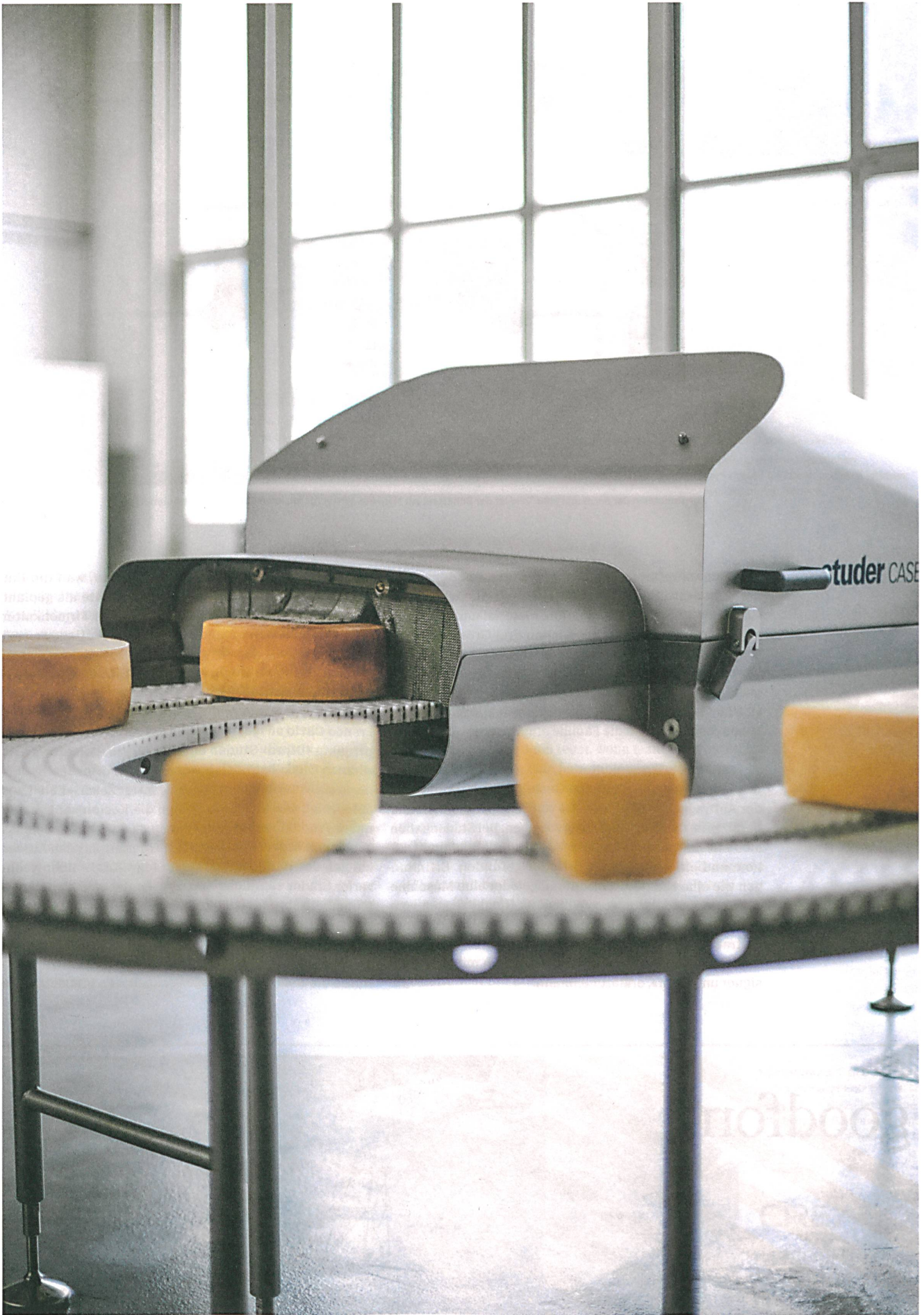
«Wo nichts ist, kann auch nichts verschmutzen», sagt der Designer Christian Lehmann. Die eigenwillig geformte Maschine mit präzise gesetzten Schrauben reinigt Käseläibe.
